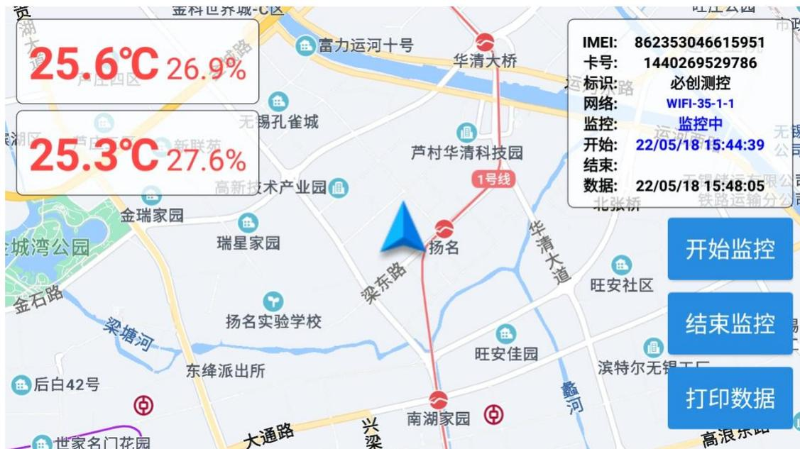
点【开始监控】，开始与车厢内温湿度探头通信，并上报温湿度数据、GPS 数据至冷链云平台。
